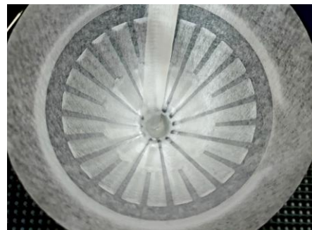
在濾紙下開通水道的逆肋骨結構
