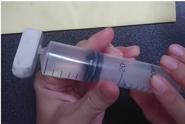
圖五：30ml 針筒裝入 10ml 的熱水，並將針口塞住
