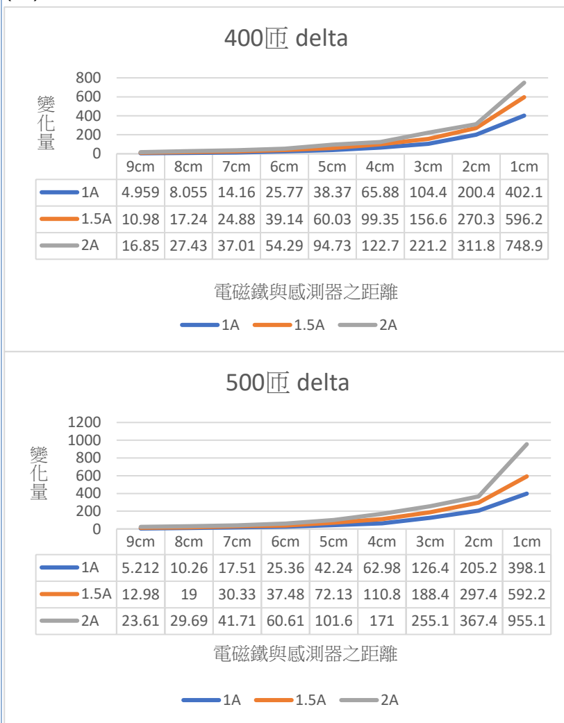
圖 3 匝電磁鐵距離與電流之磁力 delta 值
