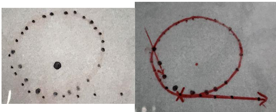
圖六：播放慢速攝影影片時，利用透明片點出及畫出小汽車運動軌跡
