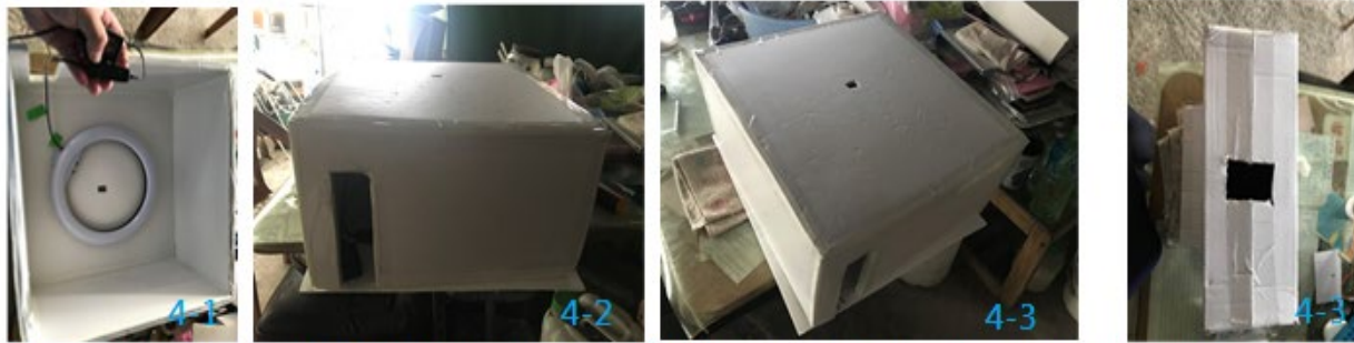
圖 4、自製拍照用燈箱 (4-1~3) 及照度測量裝置 (4-4)。使拍照環境一致，照度量測高度與實驗缸相同
