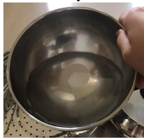
(圖四)準備一個小碗裡面有 200ml 的食鹽水，其站 35‰ 的食鹽，放在蒸餾盤上面
