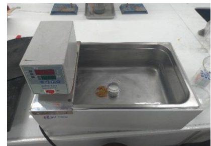
圖 使用恆溫水槽加熱情形(使用時恆溫水槽上方加蓋)
