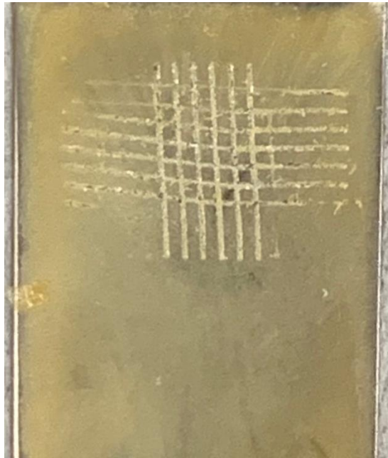
圖 4- 16 WBTOE/CYMEL327 防腐蝕塗膜於不銹鋼基材上之附著力測試
