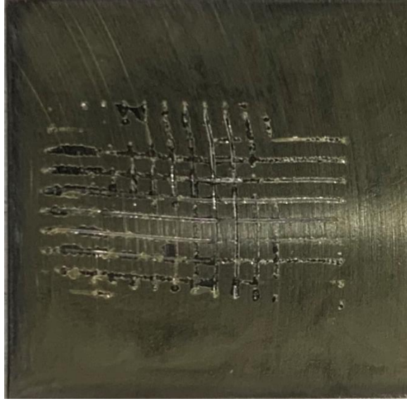
圖 4- 15 TOE/CYMEL327 防腐蝕塗膜於不銹鋼基材上之附著力測試
