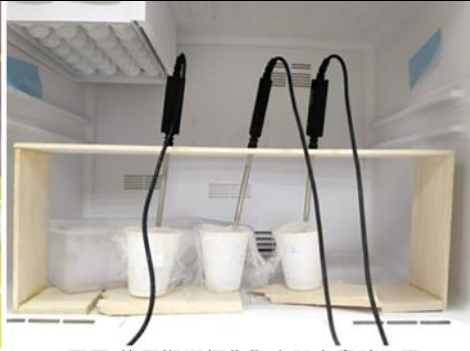
(圖二)使用塑膠杯作為容器之實驗裝置
