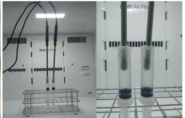
(圖六、七)使用針筒作為測量容器之實驗裝置
