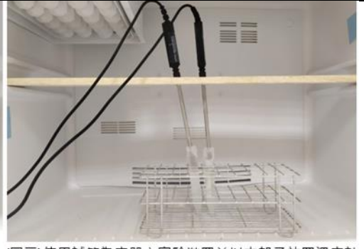
(圖三)使用試管為容器之實驗裝置並以木架子放置溫度計
