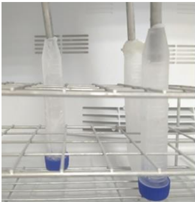
(圖四)使用倒放的試管作為容器之實驗裝置
