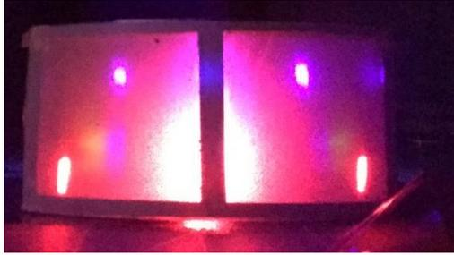
圖 1：實驗中在光譜儀成像的玻璃紙光譜，可藉由分析“強度分布”獲取光的波長和光強度數據。
