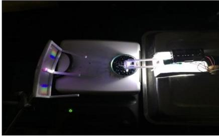
圖 4：進行本氏液加熱實驗時的情況。附註：此實驗的光譜儀與前兩次所使用的光譜儀不太一樣，這一次的光譜儀是專門設計給加熱實驗，其光柵距離被拉長，其目的是為了避免光柵的線材融化。光譜儀的高度也隨著加熱板的出現而被墊高。除此之外，光譜儀的屏幕與光譜儀本身分離了，除了可以避免融化之外，其光譜範圍也可以隨實驗需求而拉近或拉遠，不過關於拉遠與拉近，還有一個須修改的問題：弧度的調整。因為弧度的不同直接影響到光譜的範圍量。故這次實驗光柵的範圍是固定的。附註議題，此實驗以一分鐘為單位，進行測量一次。
