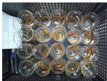
圖三 將除油後的鐵釘浸泡至 1M 的鹽酸中直到蒸發
