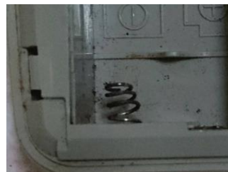
圖二 腐蝕生鏽的彈簧
