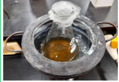
圖 3：錐形瓶放入水浴鍋加熱
