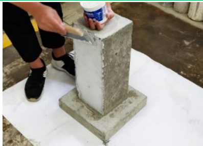
圖 7：在直立柱表面「批土」
