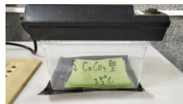
圖五:八種塑膠中將掩埋時土壤溫度 25°C 的含有碳酸鈣塑膠片放在塑膠盒中 , 並將紫外光架設好的狀態。
