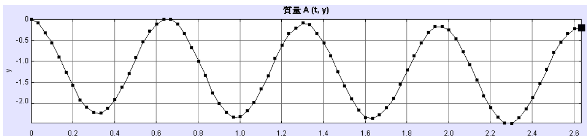
圖 2-3：彈簧 3 的修正質量 107 克(砝碼 100 克)，4 個週期時間 2.636 秒，平均週期 0.659 秒
