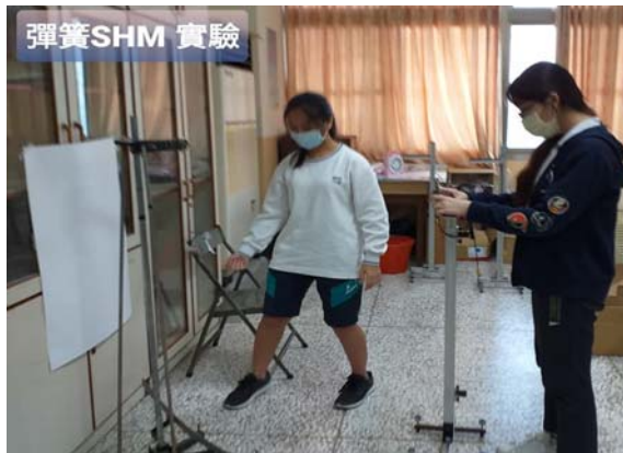
圖 1-2：實驗裝置，有支架、彈簧、砝碼及手機拍攝
