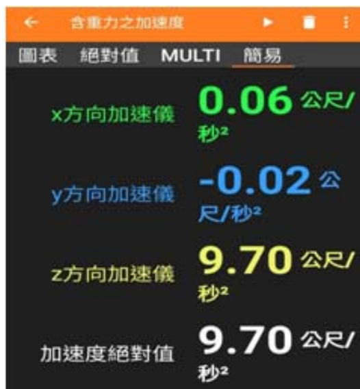
圖 3：利用 Phyphox App 量測重力加速度約 9.70 \text{ m/s}^2
