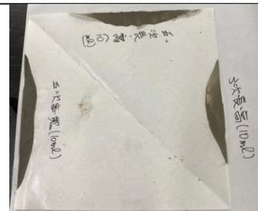
圖 4：拭鏡紙測量泥漿堆積物
