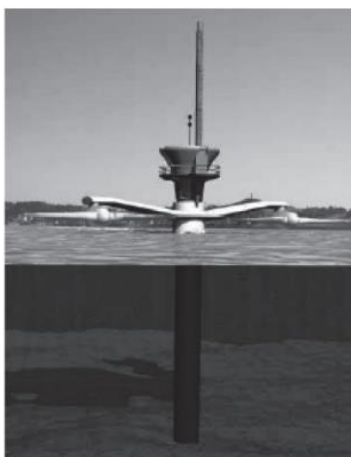
圖四 SeaGen 海流發電機示意圖 取自林盛豐論文
