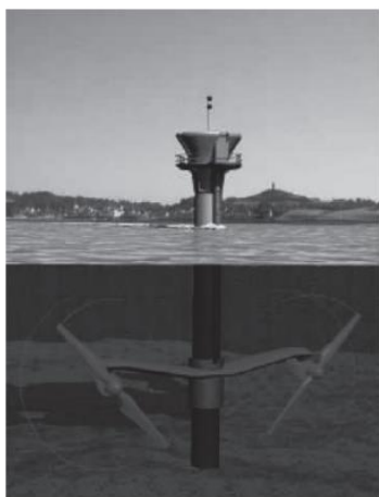
圖四 SeaGen 海流發電機示意圖 取自林盛豐論文
