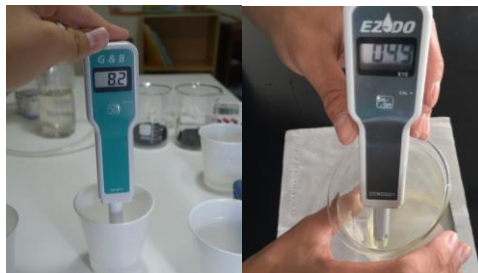
圖 10：戶外濾水潔淨系統過濾之池水 PH 值、電導值
