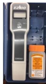
圖 3: 電導計水質測試計
