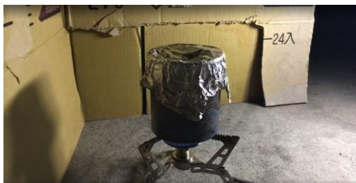
圖 5：咖啡渣生物炭製備
