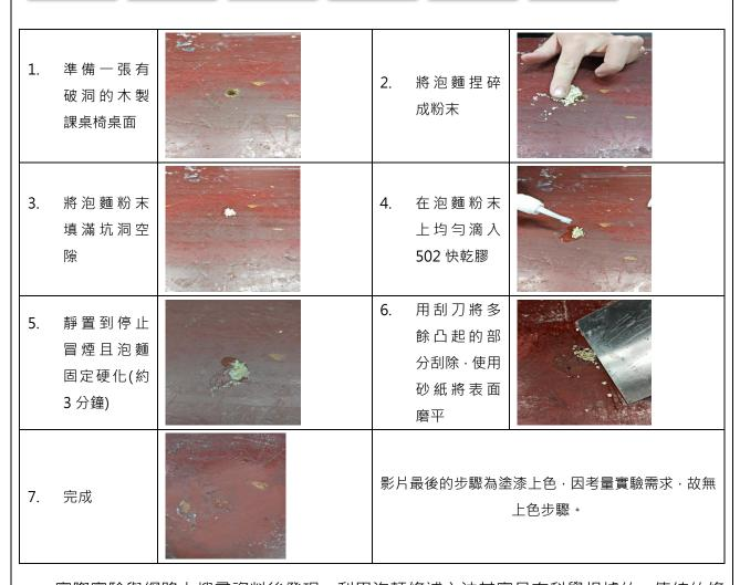
實際實驗與網路上搜尋資料後發現,利用泡麵修補方法其實是有科學根據的,傳統的修補方式是使用木屑、補土等材料填充坑洞,然後再使用特定的固化劑,或是直接用原子灰填充,而泡麵雖然是一種食物,但在修補坑洞中的作用是將空隙補滿,關鍵的材料是 502 快乾膠。快乾膠,又稱 502 膠,其主要成分為氰基丙烯酸酯,當把膠滴在泡麵上時,隨著其中丙酮的蒸發,泡麵裡或空氣中的水份,會進行陰離子聚合反應,形成長而強的鏈狀結構,將周圍物體表面黏在一起。而聚合過程是放熱反應,所以過程中溫度會輕微上升,而溶劑(丙酮)蒸發,所以會伴隨著異味。實驗過程中的確發現,泡麵滴入快乾膠時,會有冒白煙發熱的現象,之後泡麵碎層會固化成硬塊,再藉由上漆塗層達到防水防腐的效果。
