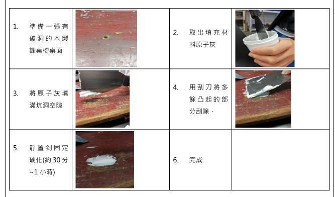
為比較兩種修補法填充物的性質,將以上步驟於矽膠模具中重複,製作出泡麵修補塊與原子 灰修補塊,比較硬度與防水性。
