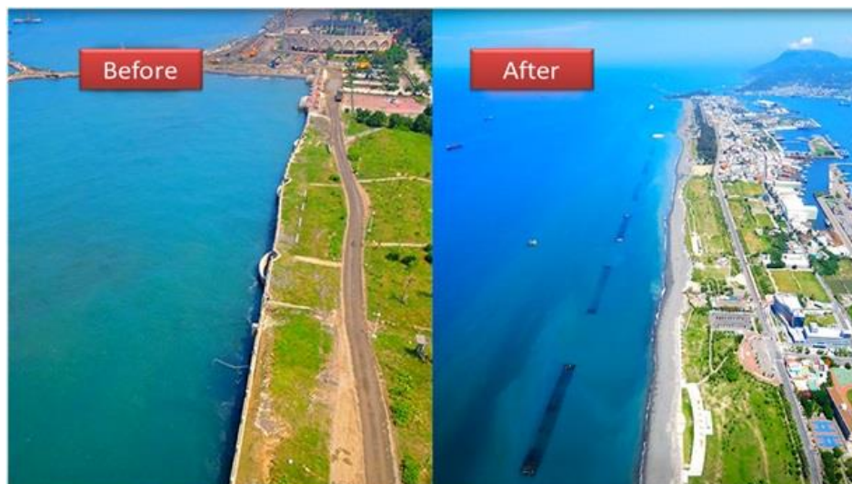
圖(十二)利用突堤效應養灘的前後差異
