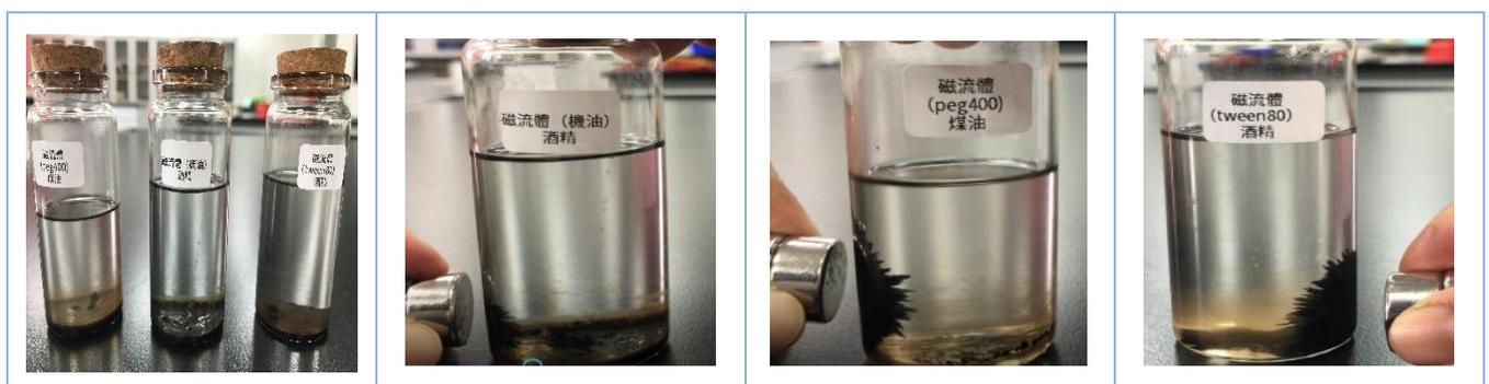
寫作草稿三：學習利用磁流體製作 ferrocell，觀察磁鐵在 ferrocell 及 led 光下所產生的磁力線。
