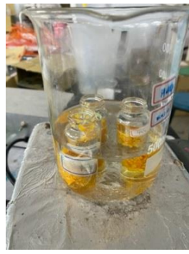
圖(四)碘酸鉀滴定裝置(控制溫度)
