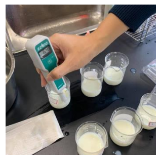
圖三、每組準備 3 杯進行測量，確保可信度，pH 計測完重新校正
