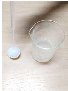
圖二、將洋菜凍溶液注入球形模具。
