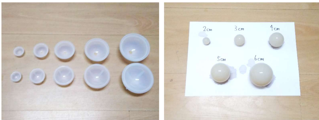
圖六、大小不同之球形模具(圖左)與所製成之洋菜凍球體(圖右)。由左上至右下之球體的直徑分別為 2、3、4、5、與 6 公分。
