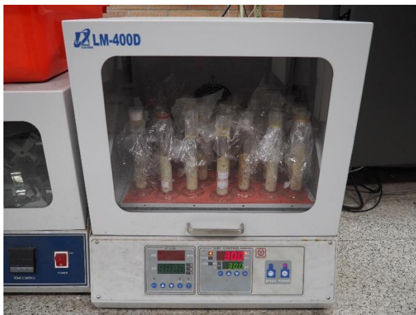
圖十五.LM-4000 恆溫培養箱可容納四個班級的發酵量筒(24 支 50mL 量筒)。
