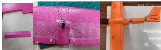
圖 2、副翼角度改善為 45 度(左)、安裝伺服馬達於機翼中央處(中)、安裝碳纖維棒加強機身韌性(右)
