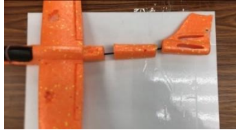
圖4、將飛機機身置入碳纖維棒示意圖
