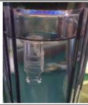
圖 9 浮沉子在側壁，受到表面張力作用
