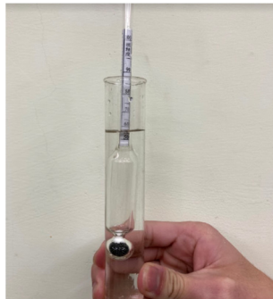
第一次蒸餾酒精濃度不到 50% 第二次蒸餾酒精濃度達到 60% 第三次蒸餾酒精濃度接近 75%
