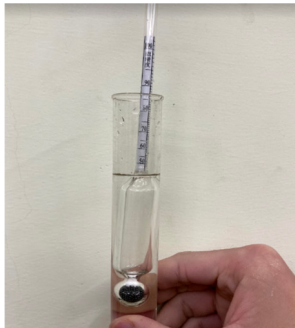
第一次蒸餾酒精濃度不到 50% 第二次蒸餾酒精濃度達到 60% 第三次蒸餾酒精濃度接近 75%
