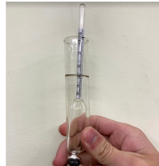
第一次蒸餾酒精濃度不到 50% 第二次蒸餾酒精濃度達到 60% 第三次蒸餾酒精濃度接近 75%
