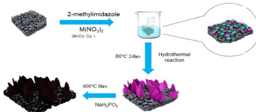
圖 (三) : 觸媒電極製作流程 ( 參考資料六 )
