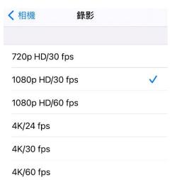
利用相機的功能可以獲得較大幀率的影片,只是檔案的容量通常相對是很大的。幸好 我們所量測的碰撞效果是短暫的,若再配合微軟上所配置的影片編輯器,再將時間軸放 大。雖然放大就造成卡頓感,但利用此卡頓的時間差和影像的微小變動就可以得到鋼珠的 平均速度。
