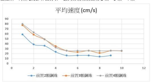
數據顯示,加速系統組合為 2 顆時,因吸力作用讓珠子的初速度僅有 59cm/s,再加上磁鐵會吸引珠子造成負的加速度讓珠子 6cm 的範圍內再受磁力減弱,遠離磁鐵後則以等速度
