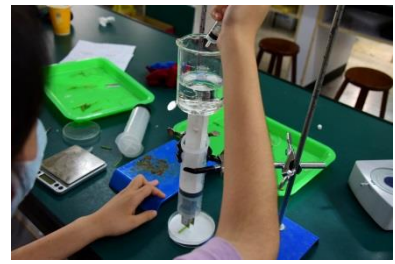
圖 27 以莖破裂時的水重換算脆度
