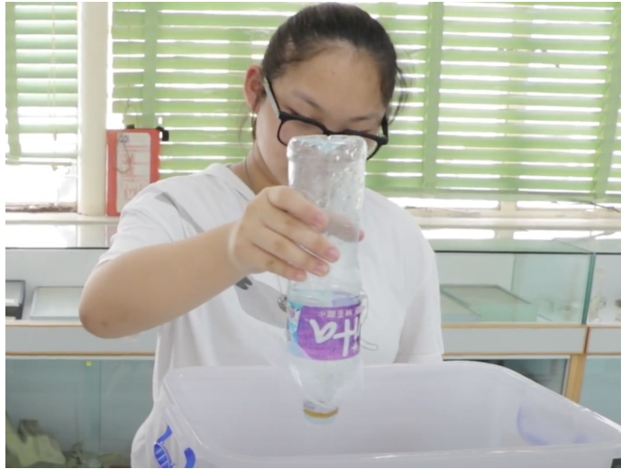
圖二、180度傾斜時的漏水情況
