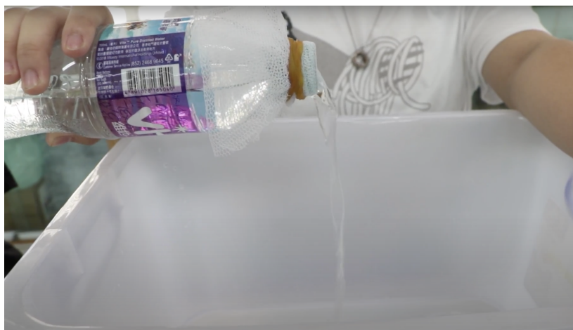
圖一、90度傾斜時的漏水情況
